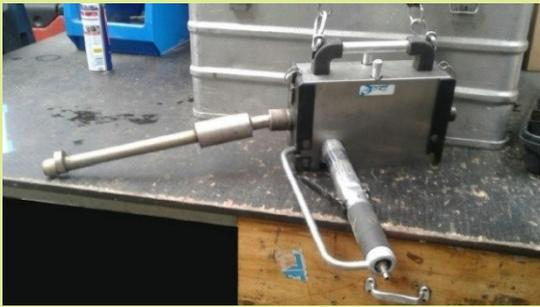
Figure n°1 : lance avec entrainement pneumatique du flexible
